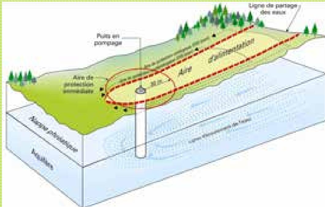
Figure 1 : Aire d'alimentation d'un ouvrage de captage
