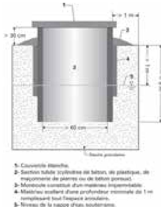
**Figure 2 : Schéma d'aménagement d'un puits de surface<sup>1</sup>**
